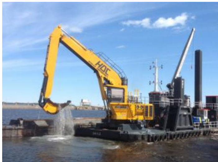
Figur 13. Exempel på enskopeverk. Bildkälla: hakandredging.se
