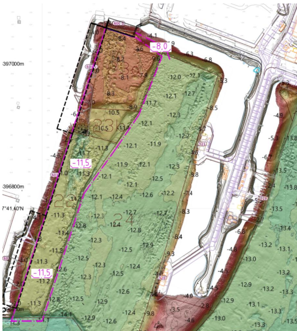
Figur 12. Sjömåtning utmed Bilterminalen. Fördjupning inom lila linjer till -11,50 m, RH2000, slänter tillkommer.
