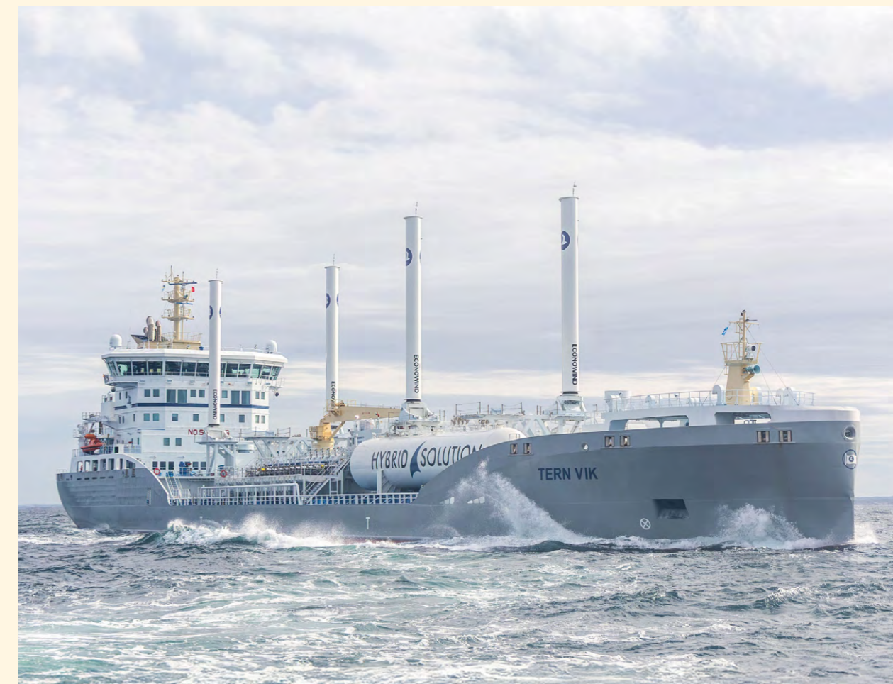
Terntanks senaste tankfartyg har nedfällbara segel som möjliggör vindassisterad framdrift.
