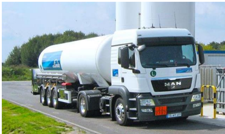
Figur 5-2 Typisk tankbil för bulktransport av CO 2 i vätskeform.
