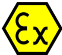
Figur 2, Märkning av Explosionsklassad utrustning kompletteras med vilken zon utrustningen är godkänd för.
